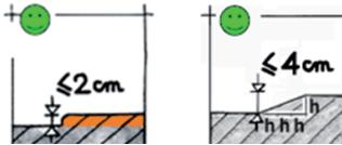
Si la marche est supérieure à 4 cm, l'entrée doit être équipée d'une rampe permanente avec un palier de repos horizontal devant la porte **ou d'une rampe amovible**, capable de supporter 300 kg, assortie d'un dispositif d'appel (sonnette située entre 0,90 m et 1,30 m du sol).
